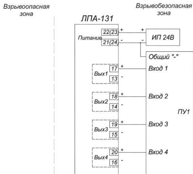
Рис. 107. Схема подключения выходных цепей барьера искробезопасности ЛПА-131 с использованием «верхних» выходных ключей
